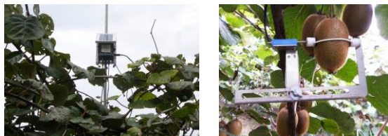
سنسور قطر میوه (راست) و سنسورهای دما و رطوبت (چپ) در سیستم آبیاری هوشمند برای بهبود تولید کیوی فروت
